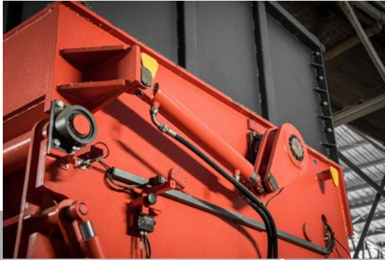
Hydraulisch bewegte Schwinge mit robustem Anlenkhebel und Schwingenlager
